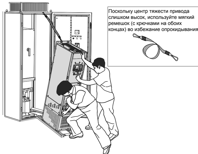
Рисунок 2-18 Вкатывание привода в шкаф
