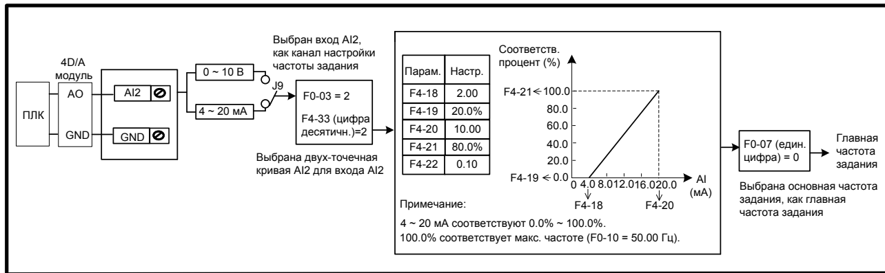
Рисунок 6-17 Входной ток AI2 для управления частотой задания
